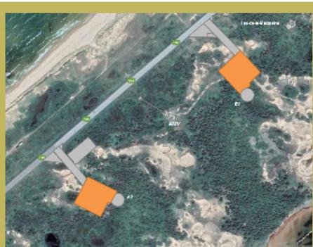
*Construction et nivellement (matériel granulaire) des aires de 60m x 60m qui permettront d'entreposer les composantes des éoliennes.*
